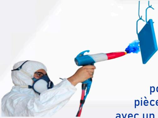
STEEL COATING est équipée d'une ligne four tunnel thermolaquage pouvant aller jusqu'à 17 mètres de longueur et qui permet le revêtement des pièces métalliques à l'aide de la polymérisation de la poudre époxy (projetée avec un pistolet sur les surfaces) qui est l'étape de la cuisson dans le four et elle se fait à des températures jusqu'à 250° selon le besoin de chaque type métal et de peinture poudre.
