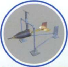
Préleveur de charge sédimentaire en suspension type bouteille de Delft
