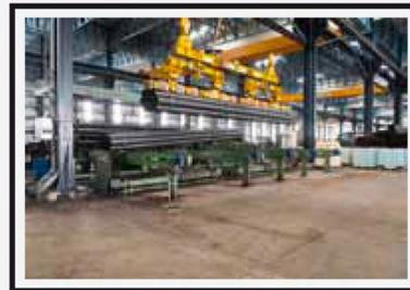
Cette catégorie de tubes est destinée à équiper les cages d'armatures, elle permet le contrôle non destructif du béton par l'auscultation sonore des pieux après exécution ;
